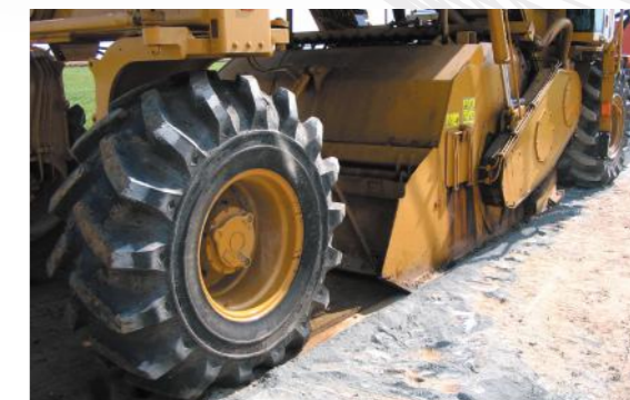
Смешение грунта с цементом и добавкой «Nicoflok»
