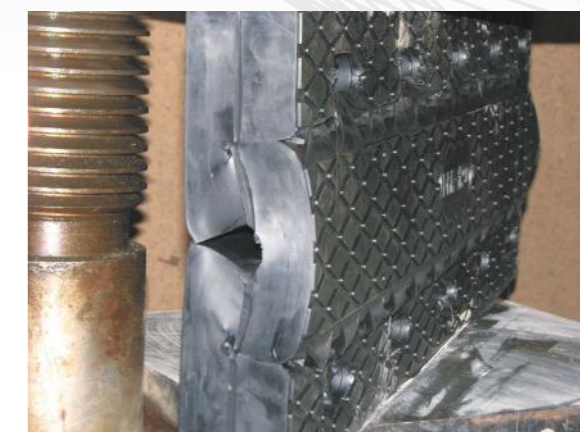
Измерение горизонтальных деформаций при максимальном усилии 69 кН
