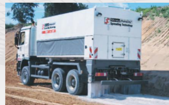
Стабилизация грунта цементом
