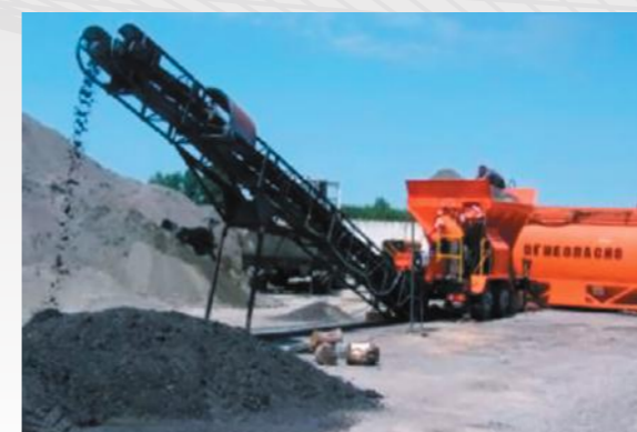
Выпуск ЭМС с использованием мобильной установки «Дельта 100» белорусского производства
