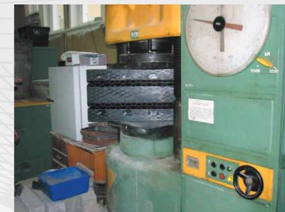
Проведение испытаний на горизонтальные перемещения (сжатие)
