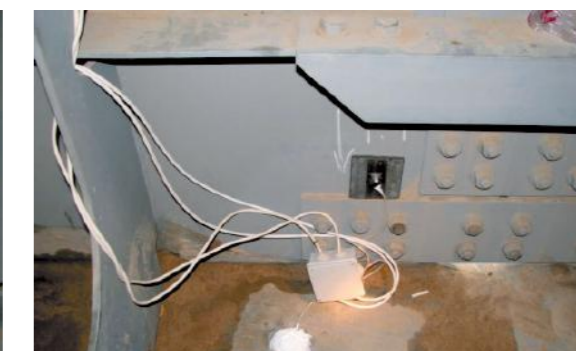
Установка датчиков на мосту через р. Сож, г. Гомель
