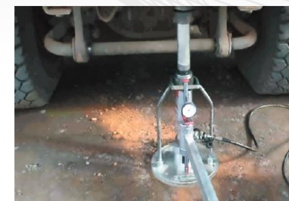
Контроль модуля упругости основания
