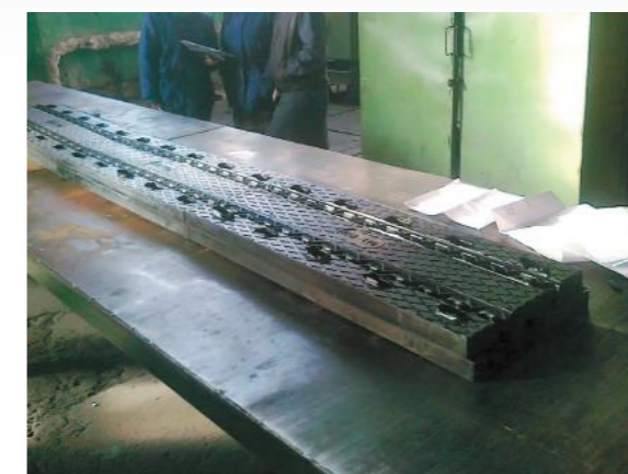
Элементы деформационного шва, объединенные в одну плет
