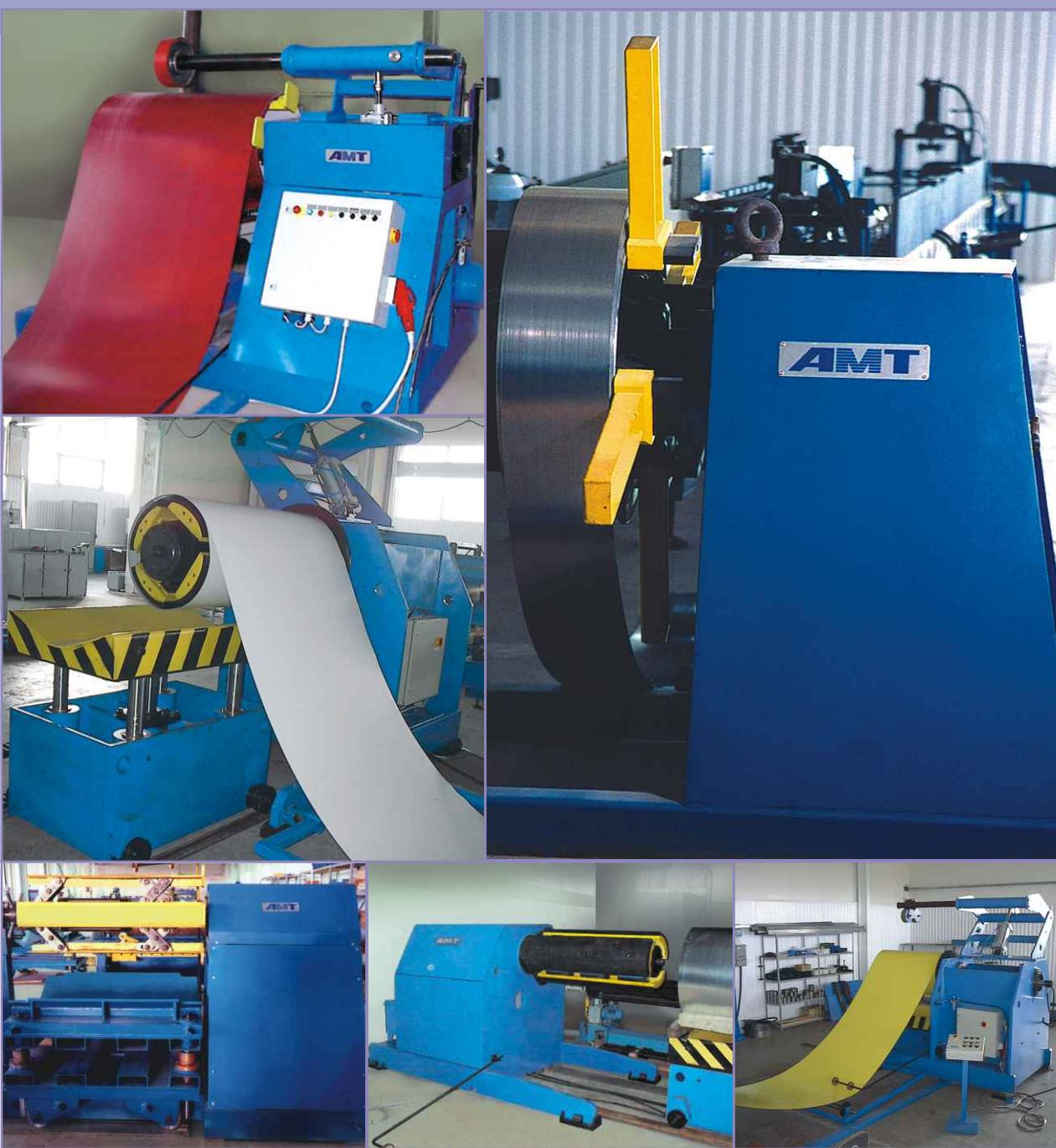
Два типа разматывателей: электромеханические и гидромеханические (оснащены подъемными тележками для съема и подачи рулона материала), имеют различную грузоподъемность (по заказу до 40 т).
