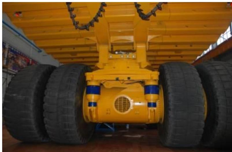
*Цилиндры передней и задней подвески самосвала являются полностью унифицированными, что позволяет оптимизировать склад запасных частей и снизить эксплуатационные расходы .*
