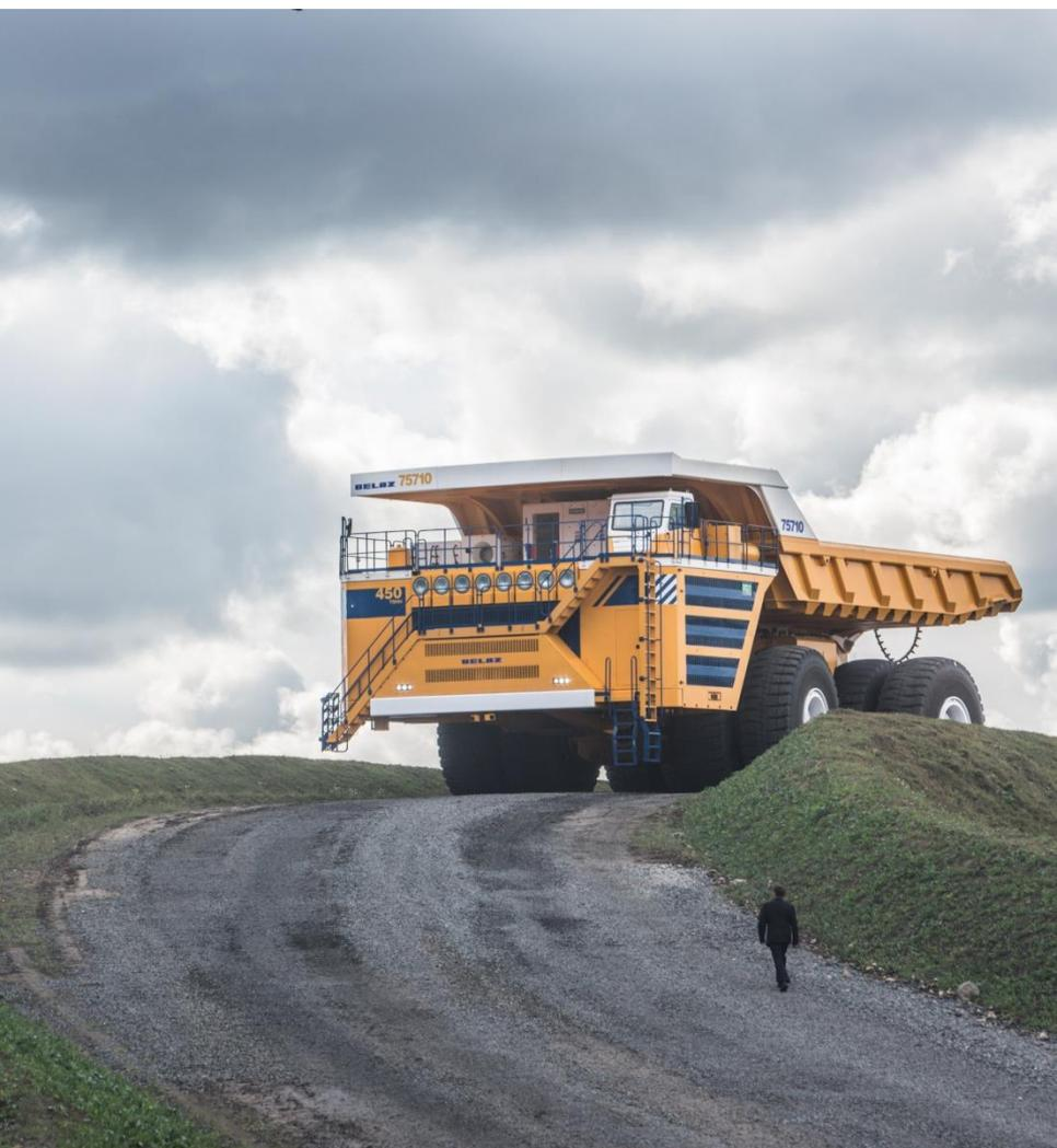
*При движении по дороге, полный привод – более эффективен, требует на 6-10% меньше энергии. В совокупности с реализацией всего сцепного веса БЕЛАЗ-75710 значительно менее прихотлив к дорожным условиям, при этом располагает более высоким скоростным потенциалом и способностью преодолевать затяжные уклоны до 18-20%.*
