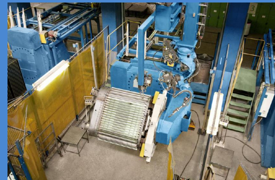
Комплекс оборудования для автоматической дуговой сварки гофрированных баков силовых трансформаторов, оснащенного сварочным роботом производства фирмы «Motoman», Япония
