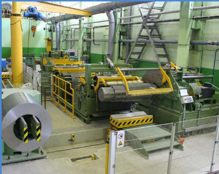
Автоматизированная линия продольного раскроя электротехнической стали производства фирмы «Georg», Германия
